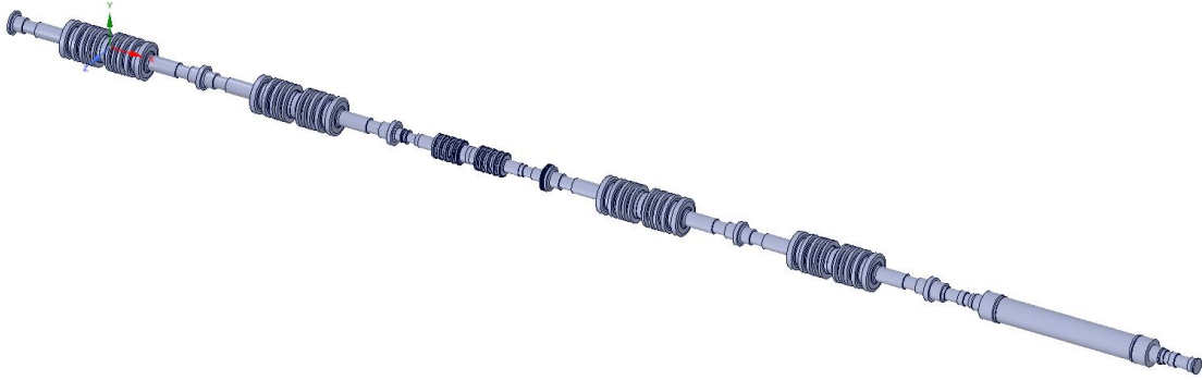
Рисунок 4.5 – Геометрична модель валопроводу ТА К-1000-60/3000
