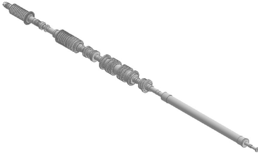
Рисунок 3.7 – Геометрична модель валопроводу ТА К-200-130 із зосередженими масами та моментами інерції
