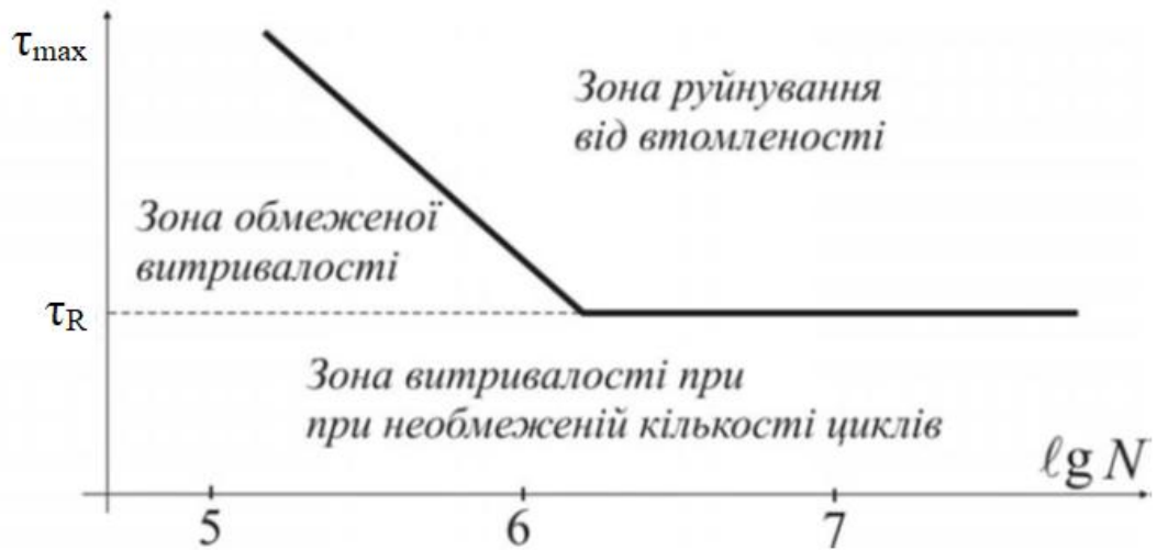
Рисунок 2.7 – Крива втоми сталі у напівлогарифмічних координатах
