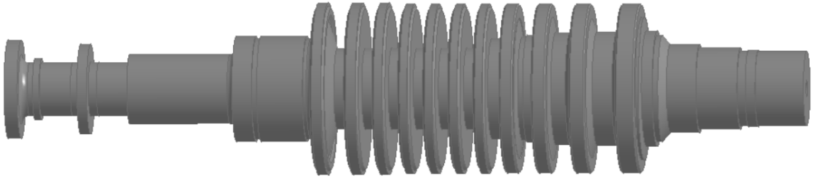
Рисунок 3.2 – Модель ротора ЦСТ з моментами інерції та зосередженими масами
