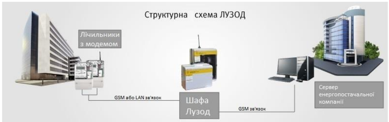
Рисунок 6.2 – Структурна схема ЛУЗОД
