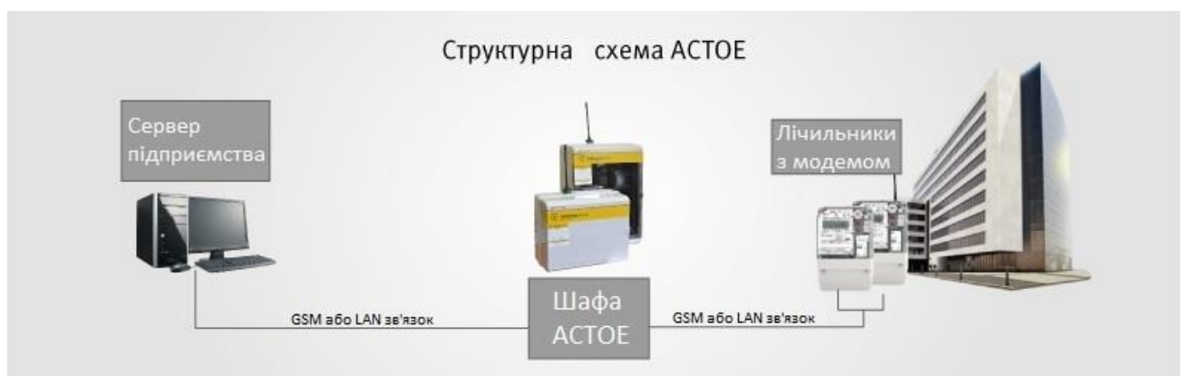
Рисунок 6.3 – Структурна схема АСТОЕ
