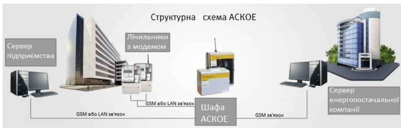
Рисунок 6.1 – Структурна схема АСКОЕ
