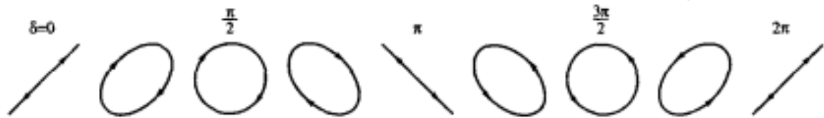
Рисунок 1.5.4 – Залежність поляризації хвилі від фазових змін [28]
