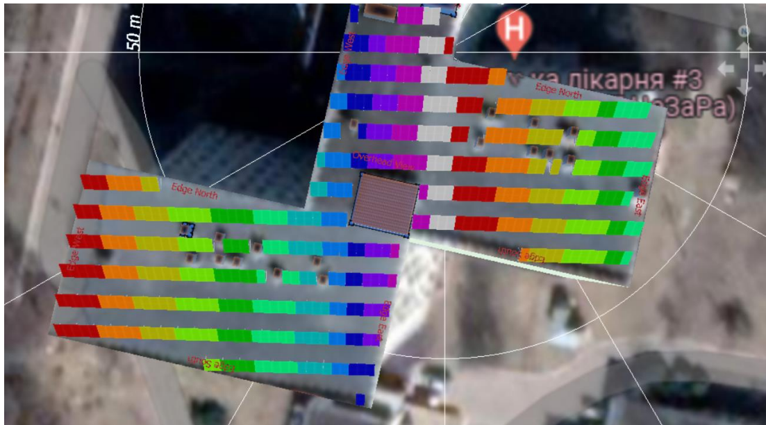
Рисунок 3.12 - Підключення панелей до MPP Trackers
