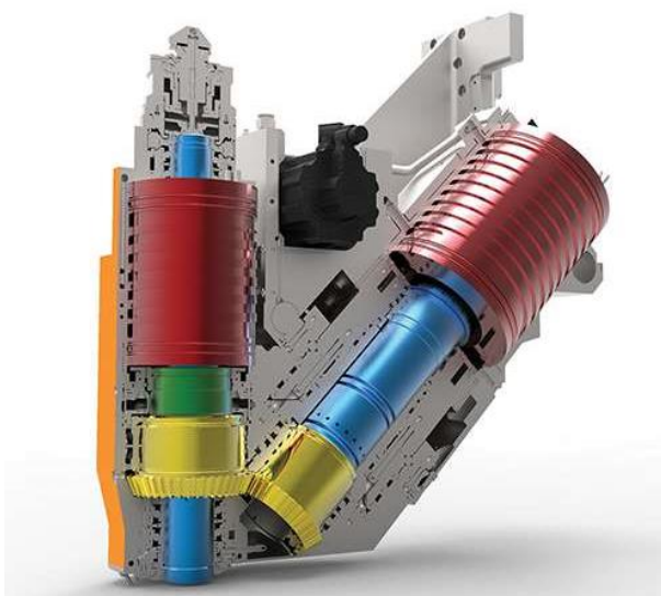
Рис. 1.4. Концепція нетрадиційного (кутового) розташування модулів шпинделів в технології подвійного приводу DDT фірми Reiden Technik (Швейцарія).
