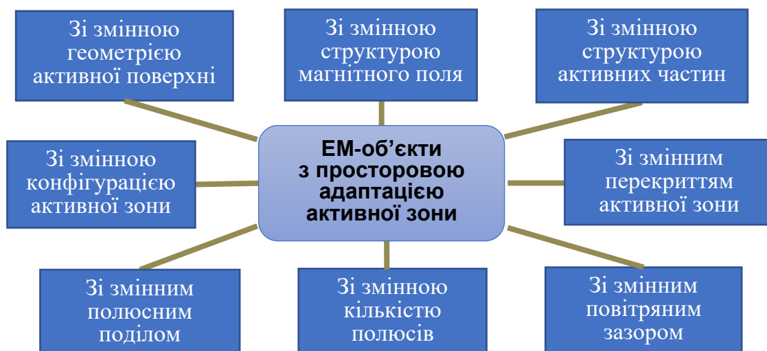
Рис. 3.2. Класифікація способів технічної реалізації ЕМ-об'єктів з просторово адаптивною активною зоною.
