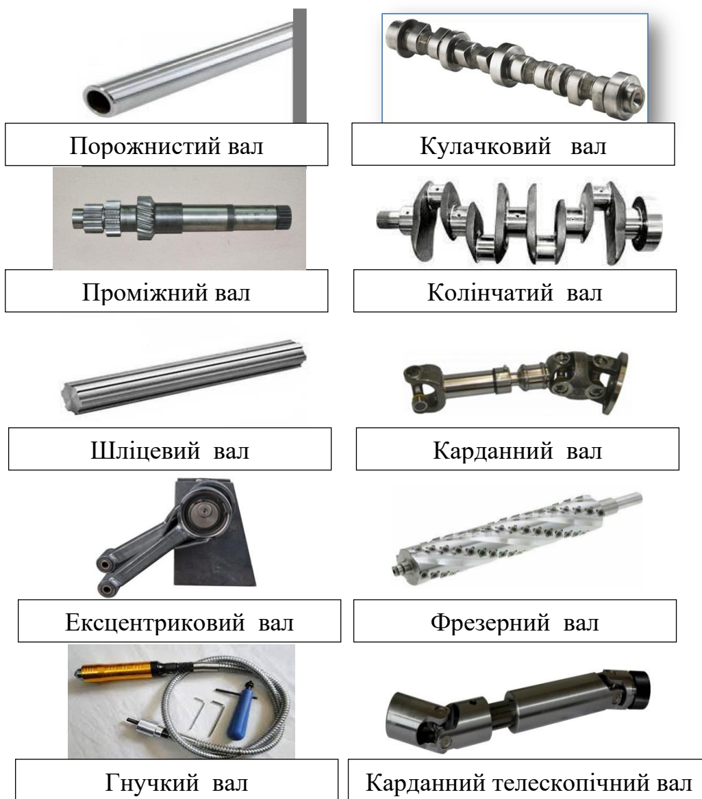
Рис. 2.6. Приклади структурних мутацій в адаптивній еволюції механічного валу.
