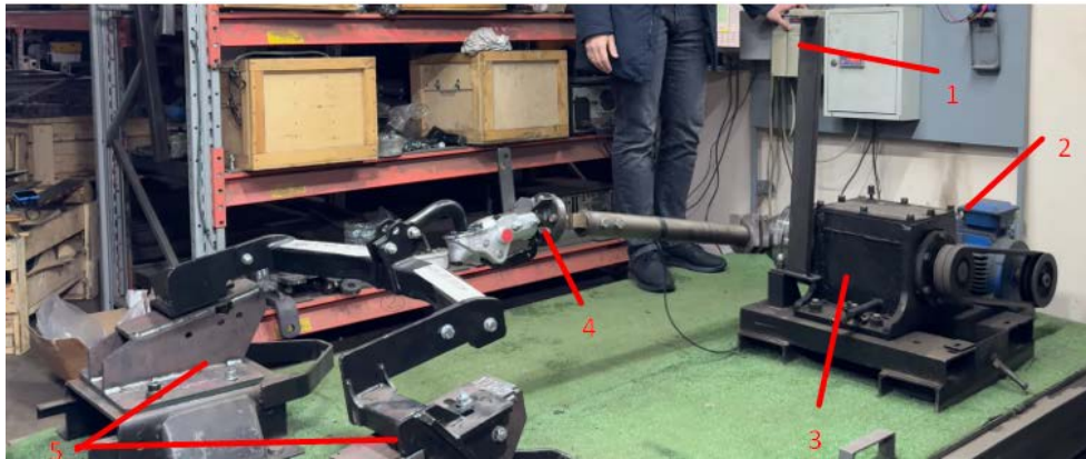
Рисунок 1.5 – Електромеханічний випробувальний стенд [30].
