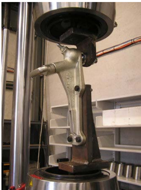
Рисунок 1.9 – Статичні випробування за допомогою гідравлічного пресу [10]
