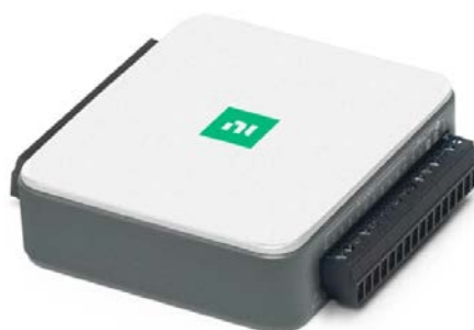
Рисунок 2.5 – Зовнішній модуль USB-6008 [18,19]
