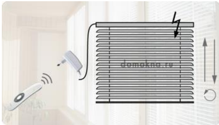
Рис. 1 Автоматичні жалюзі з електроприводом Amigo
