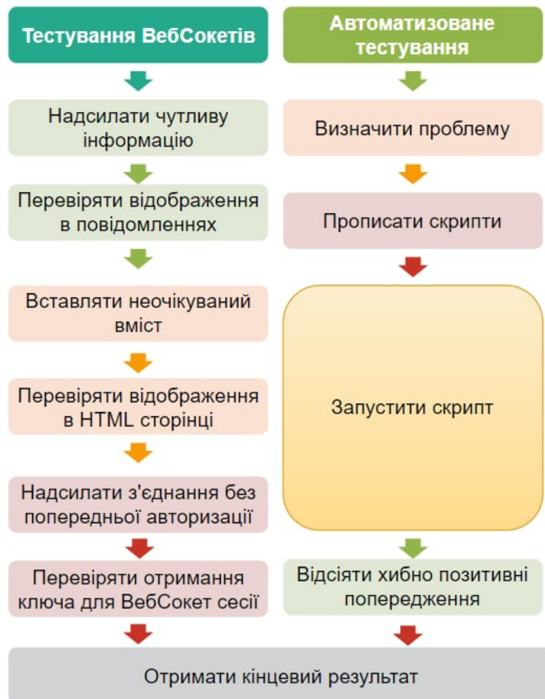
Рисунок 2.6 - Процес ручного та автоматизованого тестування
