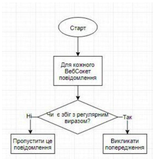
Рисунок 3.4 - Блок-схема пасивного скрипту
