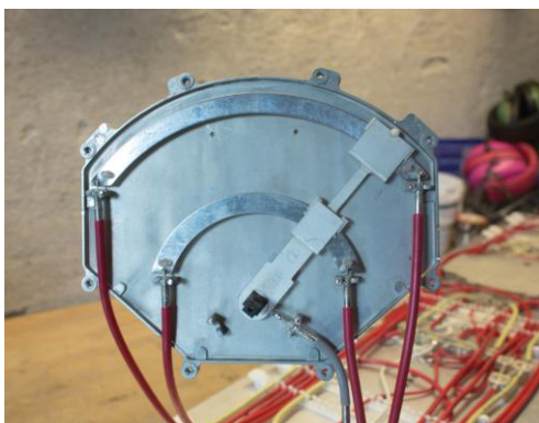
Рисунок 2.2.4 — Механізм фазозміщення антени.
