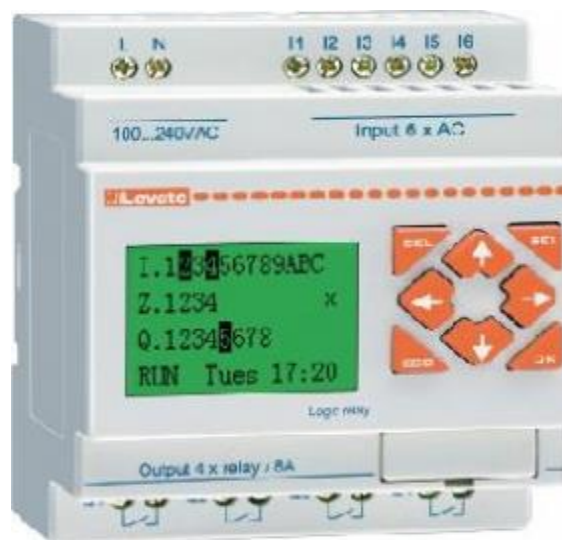
Рисунок 4.3 – Програмоване логічне реле LRD12TD024.
