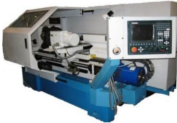
Рис. 7.4.1 - Токарно-револьверний верстат 16K20Ф3
