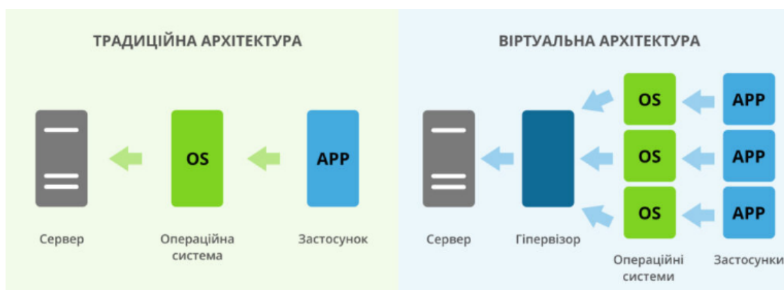
Рисунок 1.4 - Віртуалізація та традиційна архітектура
