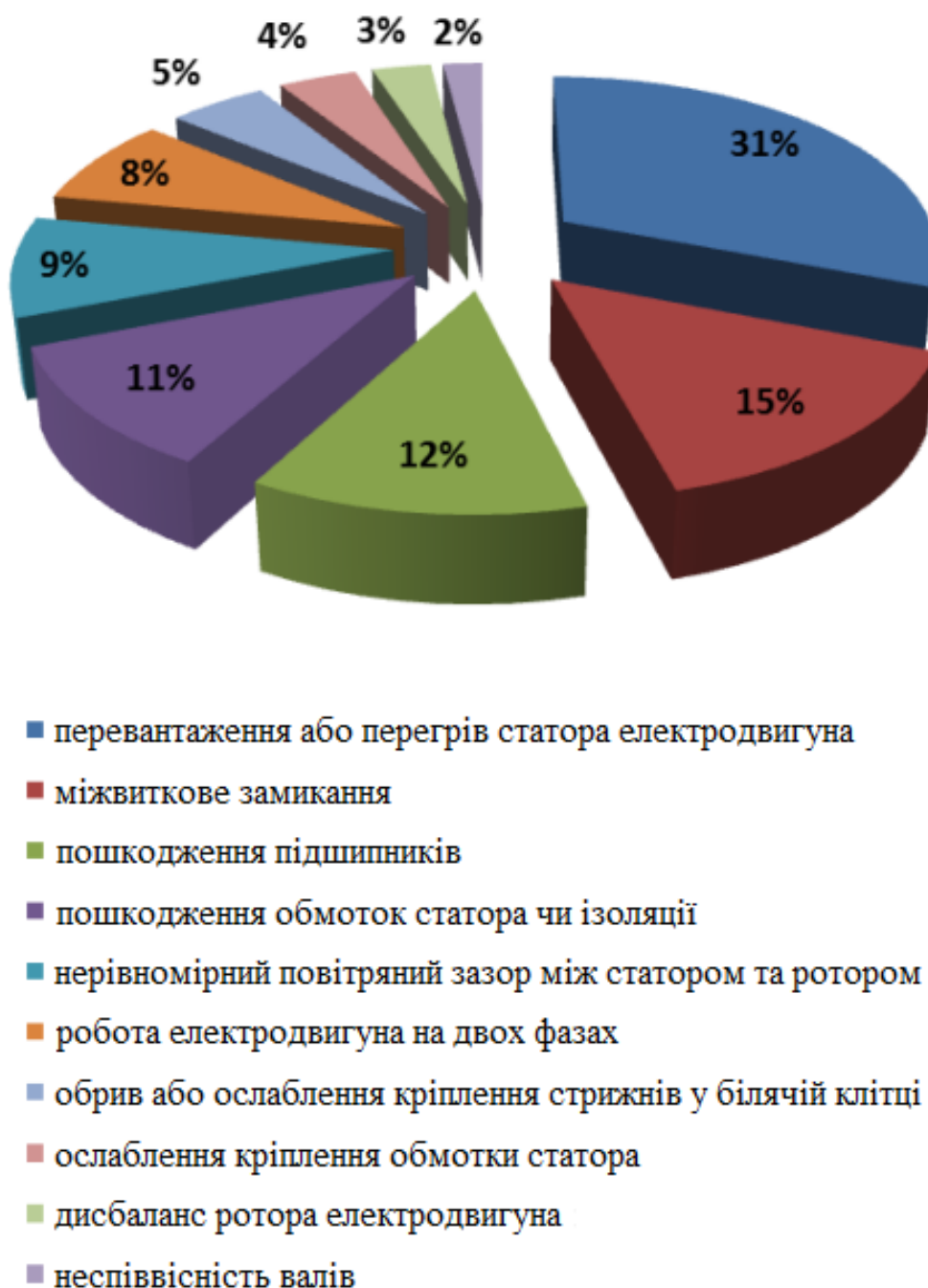
Рисунок 1.1 Джерела розвитку пошкоджень в електричних машинах
