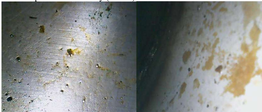
Рис. 1. Забруднення внутрішньої поверхні балону для зрідженого CO 2 та оксидна плівка (Fe 2 O 3 ), виявлені за допомогою ендоскопічної камери [Фото авторів]
