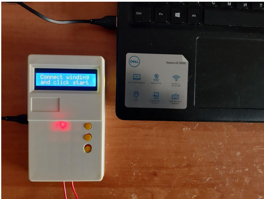
Рисунок 3.10 – Дослідний зразок приладу для вимірювання залежності повного опору від частоти під'єднаний до комп'ютера.
