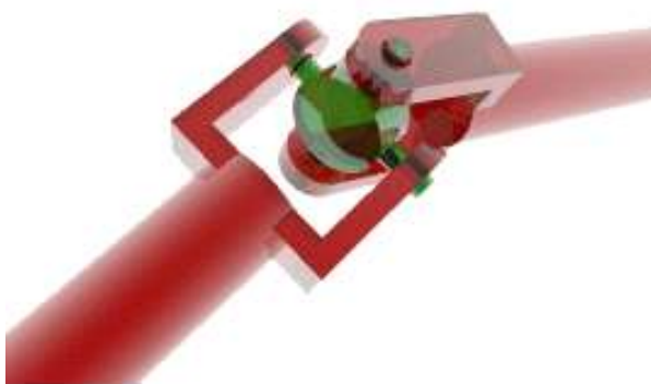
Рисунок 3.3 – Карданове з'єднання (шарнір)
