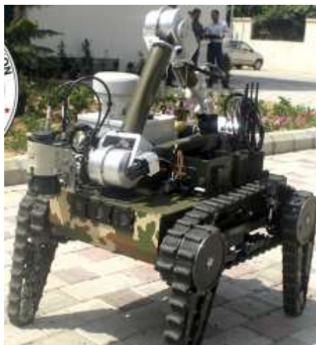
Рисунок 1.1 – Наземний роботизований комплекс для роботи з токсичними, радіоактивними та біологічно небезпечними речовинами[2]
