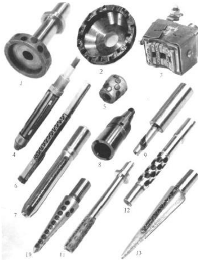
Рис. 5.23. Полікристалічні катоди для АЕОПК: 1 – круг прямого профіля; 2 – чашкове коло; 3 – головка катода для оброблення круглих зовнішніх поверхонь; 4 – хонінгувальна головка; 5 – ПК для оброблення трьох зон каналу волок; 6 – притир для ручного оброблення каналу волок з кутовим профілем; 7 – ПК для оброблення каналу редукуючих холодновисадкових матриць; 8 – трепан; 9 – ПК із сегментними полікристалічними елементами; 10 – ПК для оброблення деформуючої та калібруючої зон каналу волок з поверхневим закріпленням стовпчиків ПНТМ; 11 – катод з рядно-розподіленим розташуванням полікристалів; 12 – ПК з подовженим корпусом для оброблення внутрішніх поверхонь; 13 – конічний ПК з рядним розташуванням полікристалів для оброблення конічної зони каналу волок
