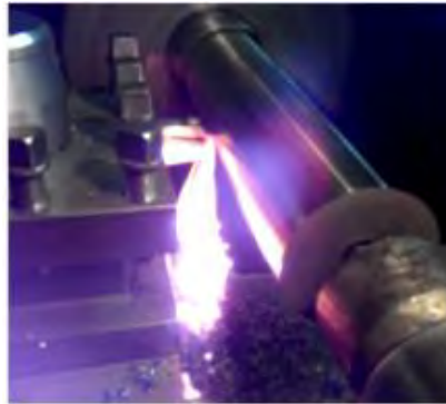
Рис. 7.12. Точіння з швидкістю різання v = 250 м/хв заготовки з загартованої сталі ШХ15 (62 HRC) інструментом з ПКНБ cBN(KM)-TiC, 55–45
