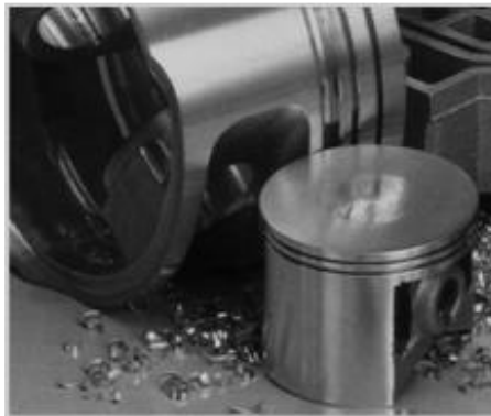
Рис. 7.2. Поршні ДВЗ, оброблені інструментом з АТП
