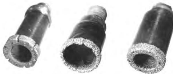
Рис. 4.28. Алмазні свердла-трепани з алмазозносним шаром, що формується методом гальваностегії
