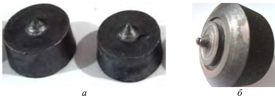
Рис. 5.19. Піни з PсVN (а) і фрагмент інструмента для зварювання тертям з перемішуванням
