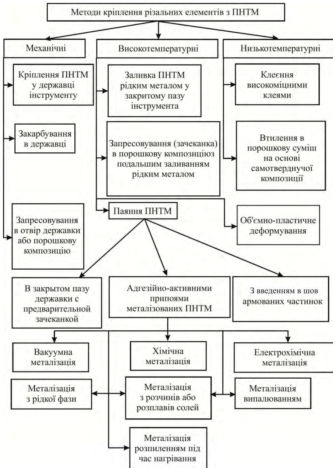
Рис. 5.1. Методи кріплення різальних елементів з ПНТМ
