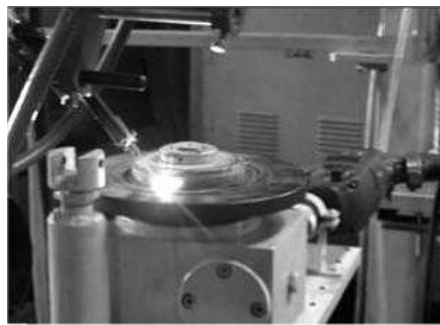
Рис. 4.5. Пошарове термодформаційне лазерне спікання алмазовмісного композиту на відрізних кругах
