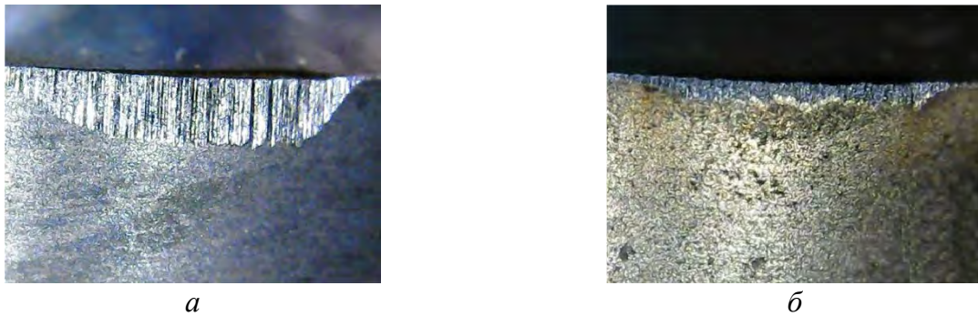
Рис. 8.10. Контактна ділянка інструменту з ПКНБ без покриття (а) і з покриттям (TiAlSiY)N (б) після 24 хв різання сталі ХВГ (58–60 HRC) зі швидкістю різання 100 м/хв
