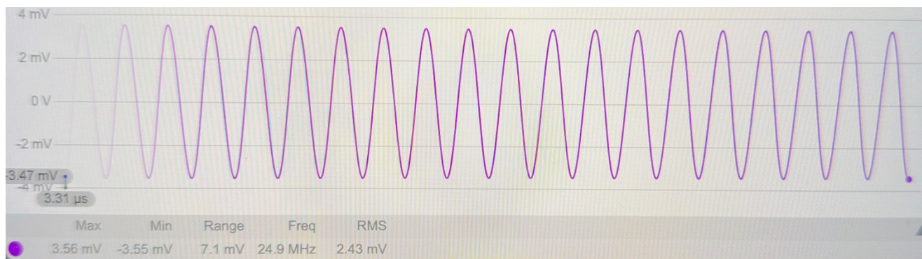
Рисунок 3.15 – Результат імітаційного моделювання схеми генератора на тунельному діоді Ai301A (див рисунок 3.14)
