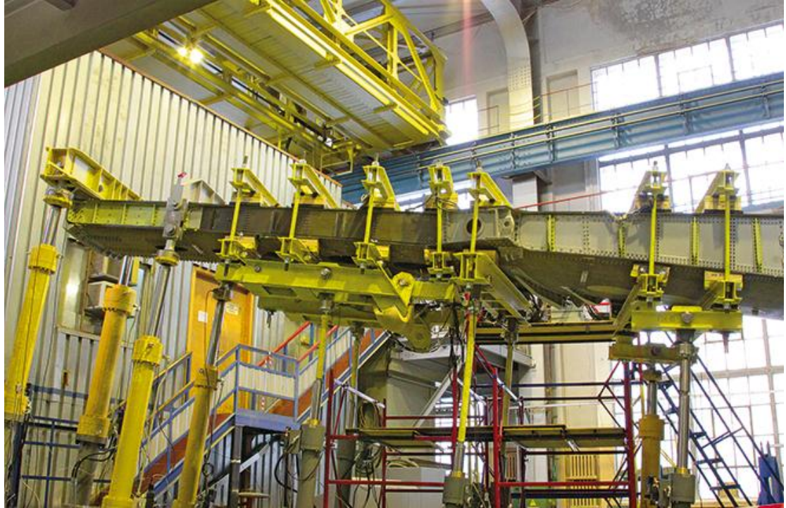
Рис. 1.5. Випробування консолі крила.
