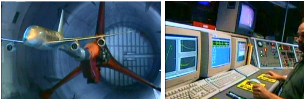
Рис. 2.15. Дренажна модель в аеродинамічній трубі.
