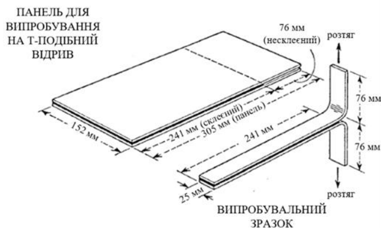
Рис. 2.5. Приклад проведення тесту відшарування Т-подібної форми [45]
