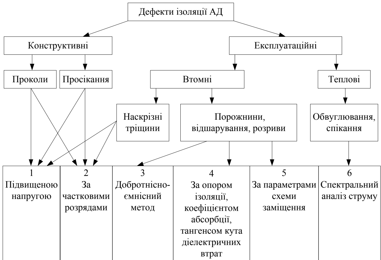
Рис. 3.1 Структурно-логічна схема дефектів ізоляції АД та методів їх діагностування
