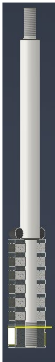
Рисунок 2.4 — Конструкція рухомого якоря електромагнітного актуатора
