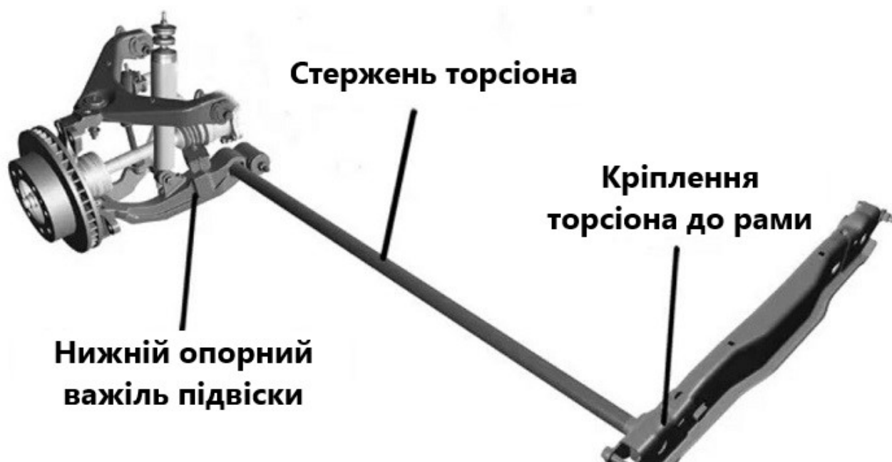
Рисунок 1.2 – Загальна будова торсіонної підвіски [21]
