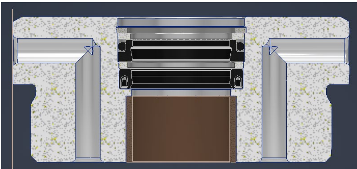
Рисунок 2.5 — Конструкція верхньої кришки стійки з елементами Trelleborg, втулкою SF-1 та повітряними каналами (3D-модель у розрізі)
