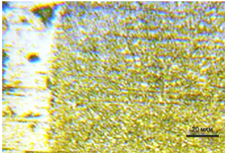
Рисунок 3.2 – Мікроструктура легованого шару сталі ХВГ після проведення ЕІЛ за схемою \text{Co} - \text{Nb} - \text{C} - \text{Ti} товщиною 25 мкм
