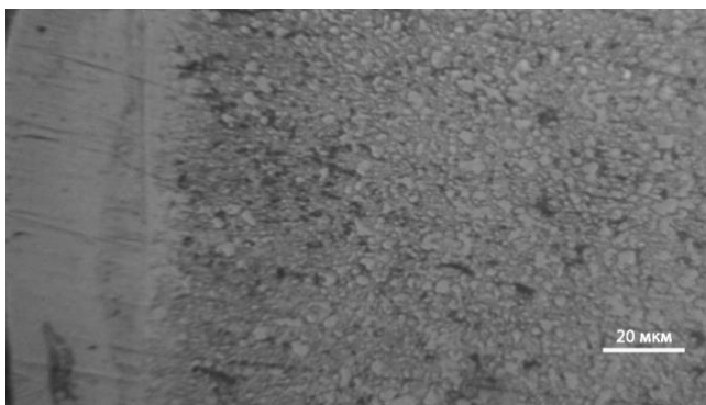
Рисунок 3.6 – Мікроструктура поверхневого шару сталі ХВГ після ЕІЛ Nb – С – Тi – С – Со товщиною 35мкм
