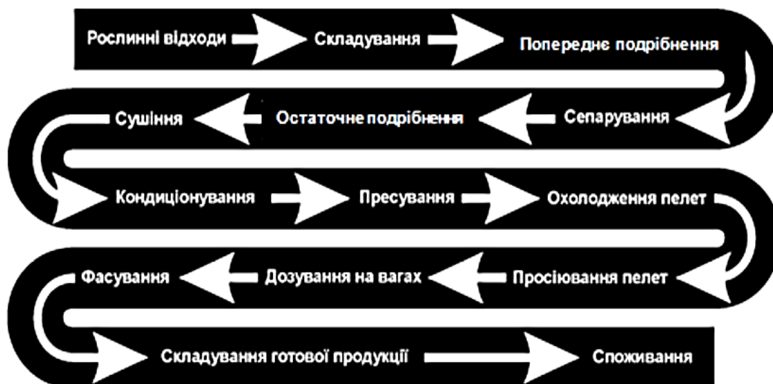
Рисунок 3.4 – Технологічна послідовність виготовлення пелет з рослинних відходів
