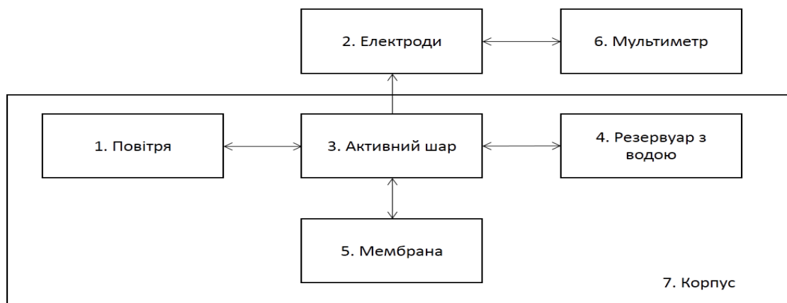
Рисунок 4.1 — Функціональна схема паливного елемента на воді.
