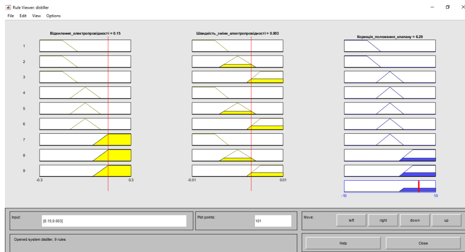
Рисунок 3.14 – Вікно Rule Viewer для вхідних значень \Delta C = 0,15 , \frac{dC}{dt} = 0,003 ,
