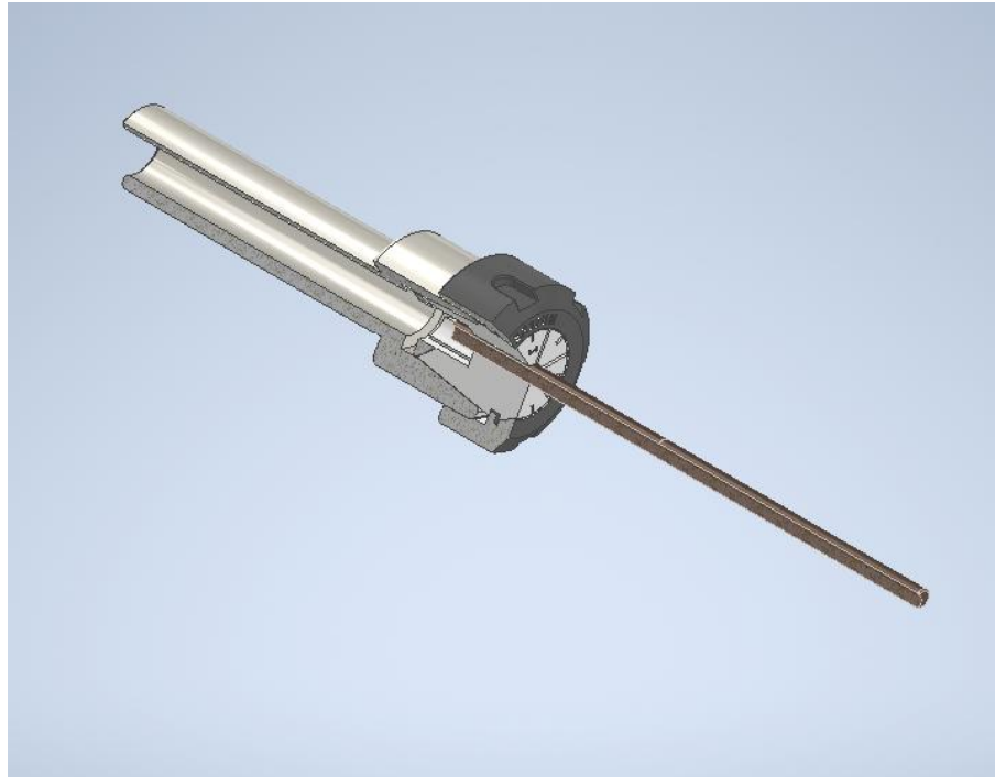
Рисунок 1.2 — Будова затискного механізму з цангою ER32.
