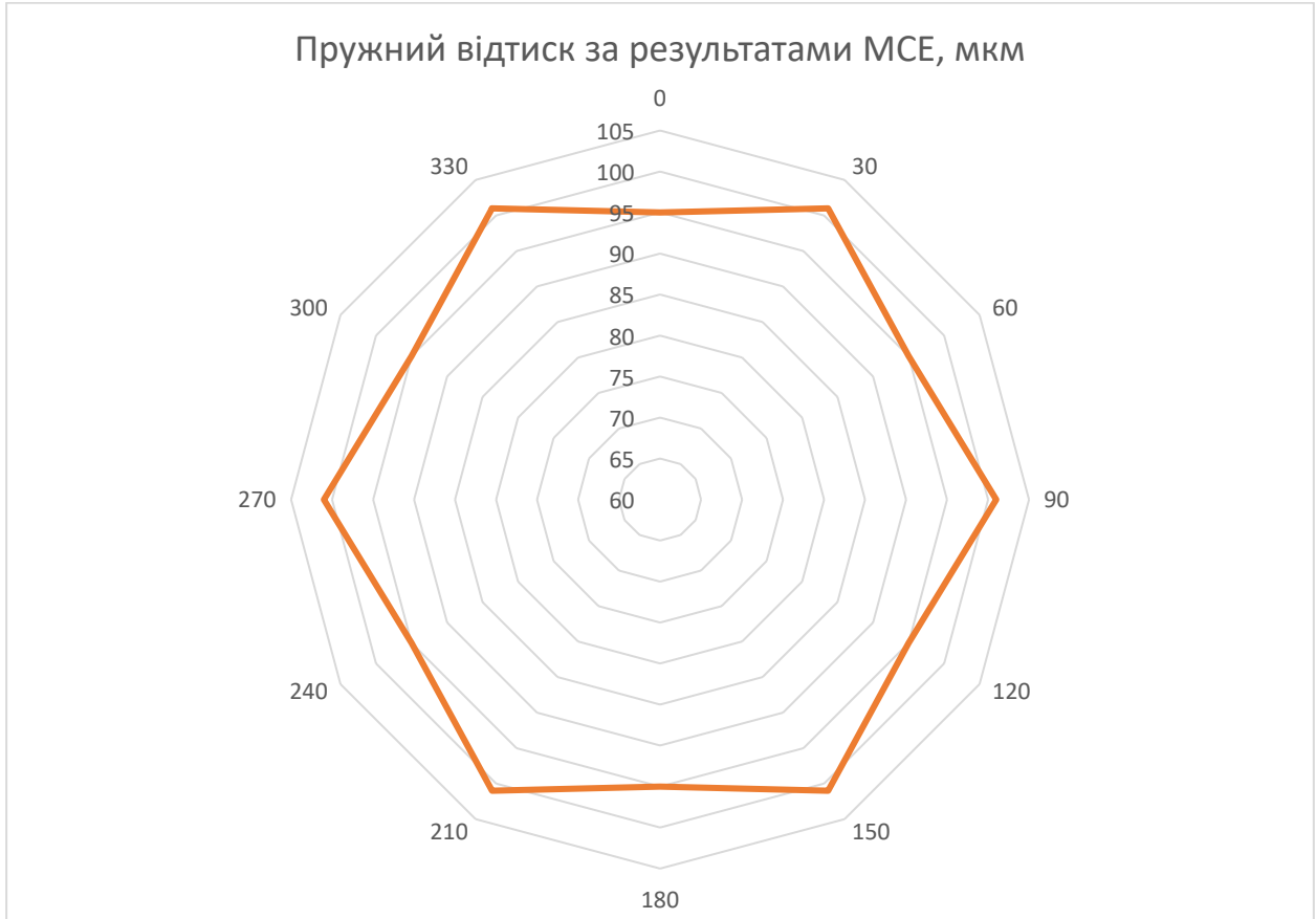
Рисунок 3.4 — Теоретична полярна діаграма пружних відтисків системи за даними МСЕ
