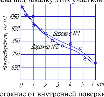
Рис. 4. Микротвердость по сечению двух дорожек внешнего кольца подшипника из стали У8А после объемно-поверхностной закалки
