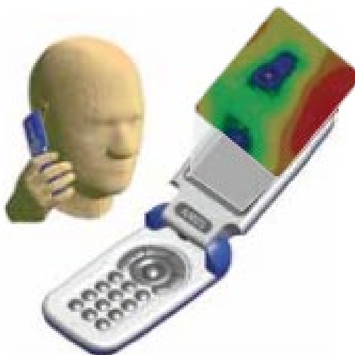
Рисунок 3.4 - Оцінка випромінювання антени мобільного телефону – приклад застосування методу FDTD
