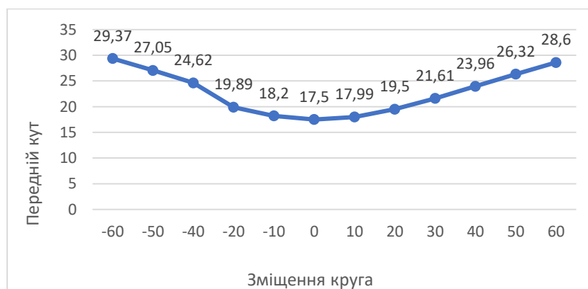
Рисунок 2.26 – Графік залежності переднього кута від зміщення круга
