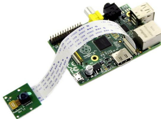
Рис. - 2.7 Raspberry Pi Camera Module V2 підключений в необхідний роз'єм [26]
