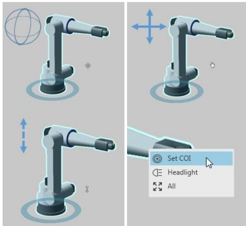
Рисунок 1.3 – Переміщення положення робота
