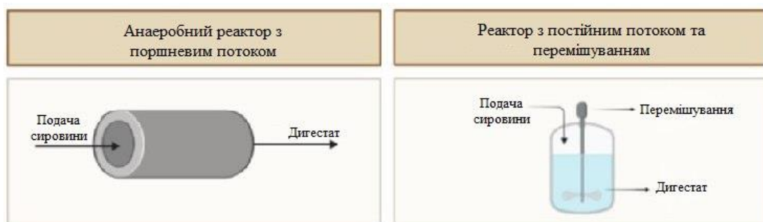
Рис. 1.2.1.1 Схематичне зображення реактора з безперервним потоком та перемішуванням та анаеробного реактора з поршневим потоком [41]
