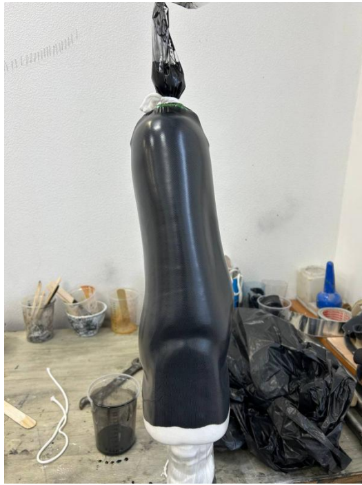
Рисунок 2.5 – Ламінування куксоприймальної гільзи
