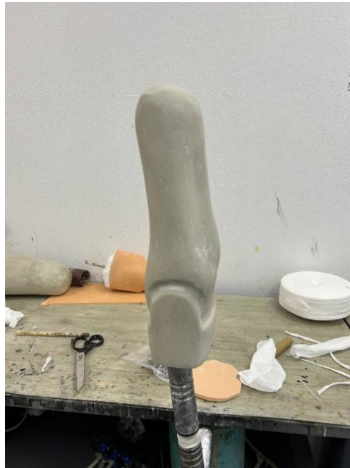
Рисунок 2.3 – Модель, готова до ламінування
