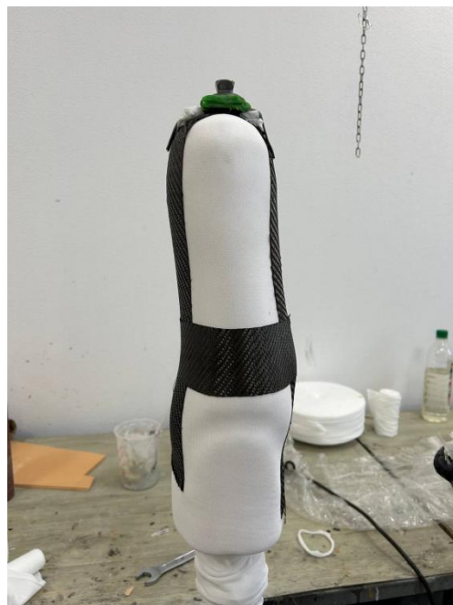
Рисунок 2.4 – Додавання карбонових волокон та налаштування адаптеру
