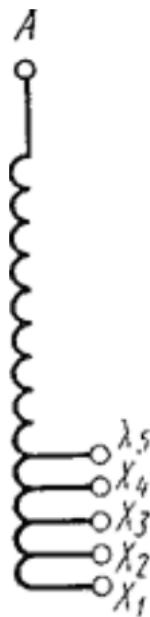
Рисунок 1.5 – Схема розміщення регулювальних відгалужень поблизу нейтралі
