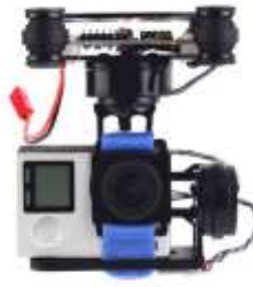
Рисунок 3.38 — Гіростабілізована платформа з встановленою камерою [8]
