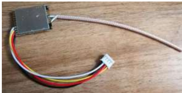
Рисунок 3.35 — Відеопередавач на 1,2 ГГц [5]
