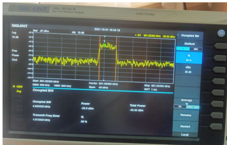
Рисунок 2.5 PSD згенерованого GSM сигналу
