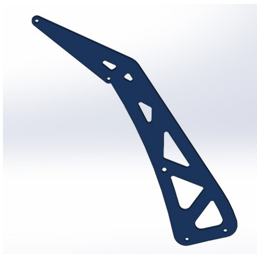
Рисунок 3.26. Оптимізована геометрія стійки swan-neck: а) геометрія; б) масові характеристики
