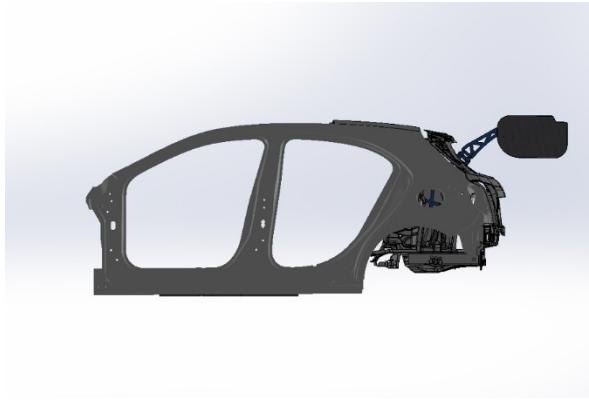
Рисунок 3.4. Розташування антикрила відносно кузова: а) збоку; б) зверху
