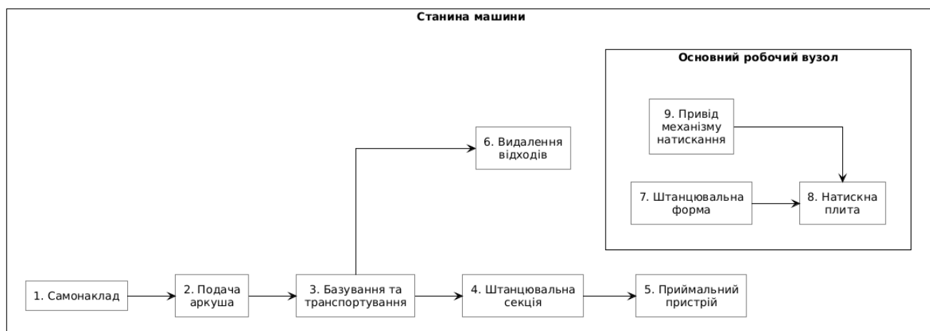
Рисунок 1.1 – Конструктивна схема штанцювальної машини плоскопресового типу
