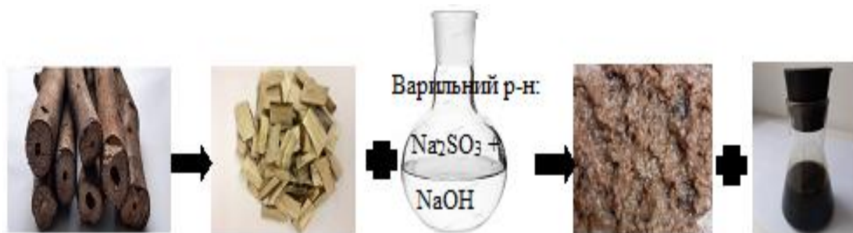
Рисунок 2.4 – Схематичний процес варіння (делігніфікації) деревини лужно-сульфітним способом
