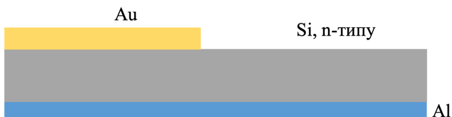
Рисунок 4.1 – Структура діода Шотткі, який було досліджено
