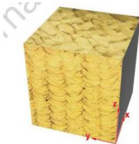
Рисунок 1.6 – 3D-модель зразка СЛТ, що ілюструє мікроструктуру залежно від напрямку друку [42]
