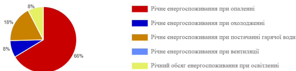
Діаграма річного енергоспоживання будівлі
