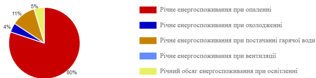
Діаграма річного енергоспоживання будівлі
