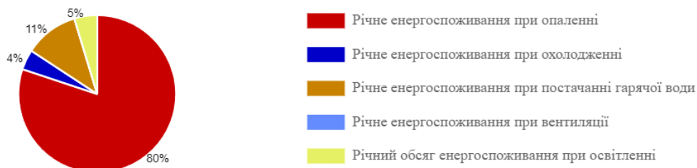
Діаграма річного енергоспоживання будівлі
