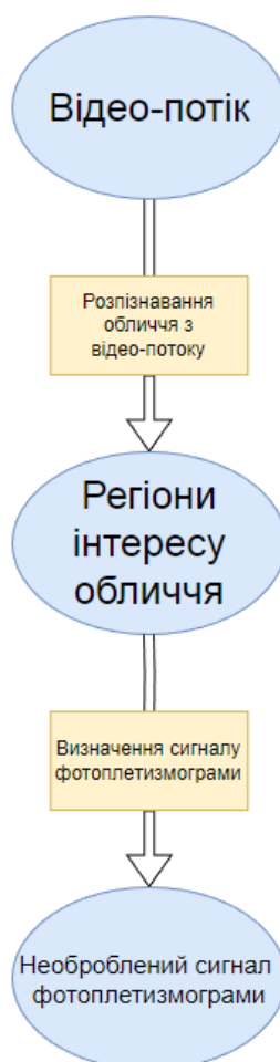
Рисунок 2.7 – Блок-схема структури визначення фотоплетизмограми з відео-потіку
