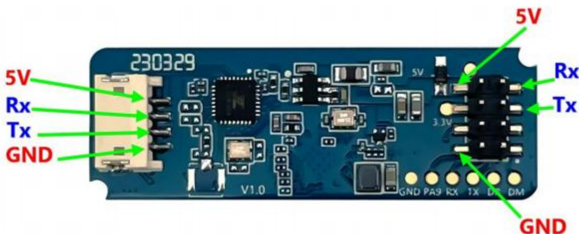
Рисунок 2.3 – Радіолокаційний модуль Hi-Link HLK-LD2450: Функціональна схема призначення виводів інтерфейсного роз'єму [15]
