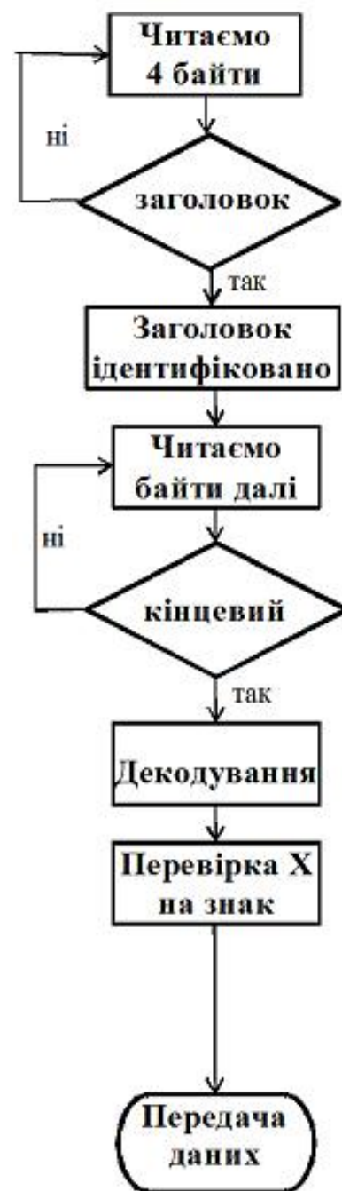
Рисунок 2.5 – Алгоритм обробки вхідного потоку даних
