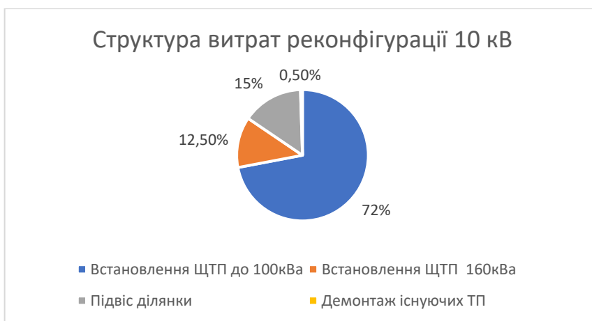
Рис.3.2 – Структура основних витрат при реконфігурації мережі 10 кВ
