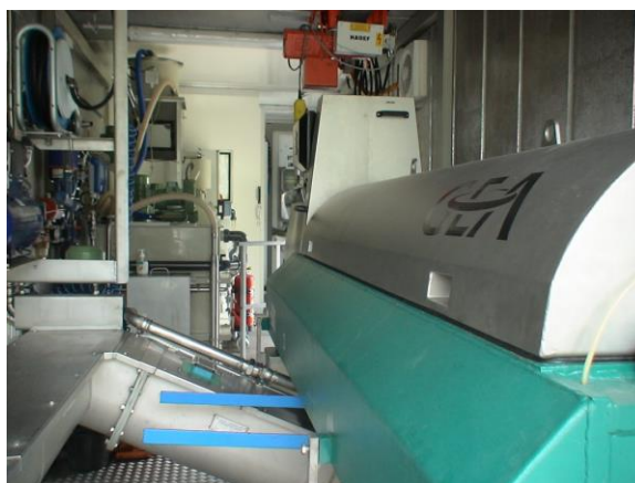
Рисунок 3.15 – Відцентровий декантер, презентований 09.08.2011 на ДВС
