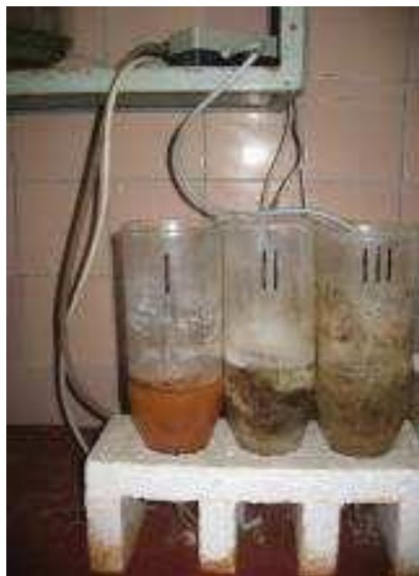
Рисунок 3.4 – Лабораторна установка для очищення стічних вод, що містять ГМД
