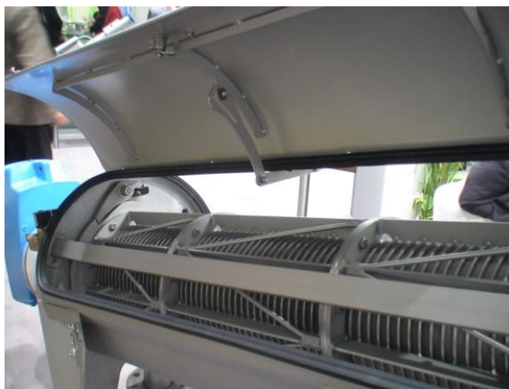
Рисунок 3.17 – Шнековий прес HUBER ROTAMAT RoS 3Q
