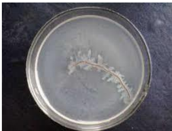
Рисунок 3.6 – Біоплівка, що виросла на волокнистому носіїві ВІЯ
