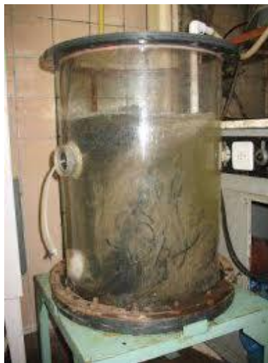
Рисунок 3.5 – 40-літровий реактор відкритого типу
