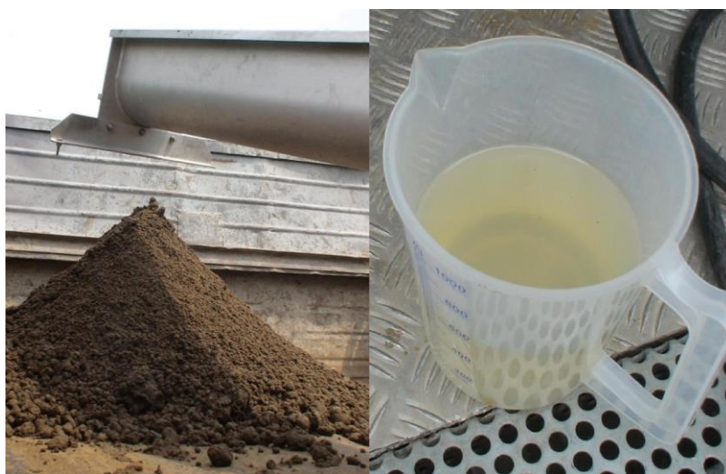
Рисунок 3.11 – Осад (зліва) та центрат (справа) після тестового зневоднення
