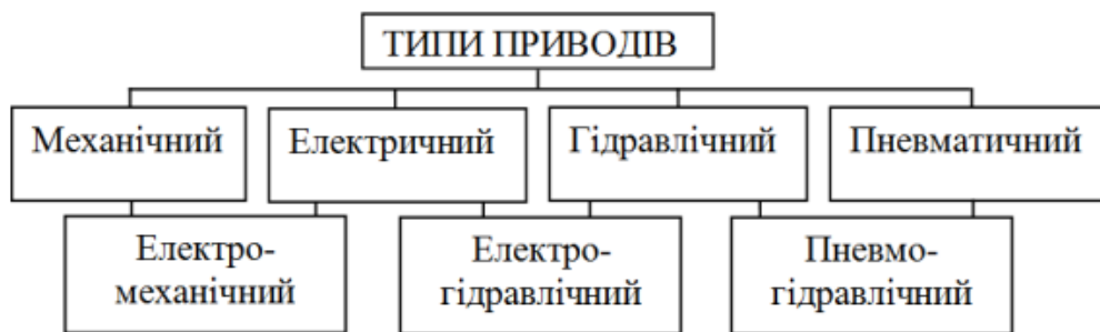
Рис. 1.2. Класифікація приводів за видами енергії
