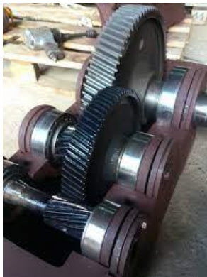
Рис. 2.6. Циліндричний двоступінчастий редуктор: a – загальний вид; б – компоновка, де 1 – корпус; 2 – кришка корпусу; 3 – вал швидкохідний; 4 – проміжний вал; 5 – тихохідний вал; 6, 7 – колесо зубчасте; 8 – кришка наскрізна; 9 – кришка глуха; 10 – шпонка; 11 вал – дистанційне кільце; 12 – мастилозахисна шайба; 13 – болт; 14 – підшипник; 15 – штифт; 16 – пробка; 17 – мастилопоказчик; 18 – оглядовий люк; 19 – душник; 20 – віджимний гвинт; 21 – ущільнення
