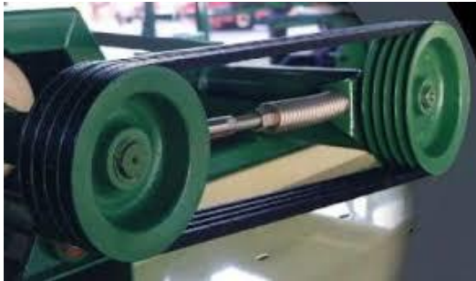
Рис. 5.1. Пасова передача: a – загальний вид; b – схема
