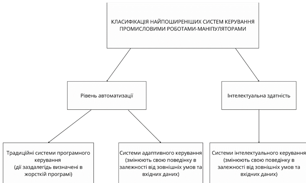
Рисунок 1.20 Блок-схема класифікації систем керування промислових роботів-маніпуляторів
