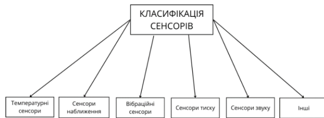
Рисунок 1.17 Блок-схема класифікації сенсорів
