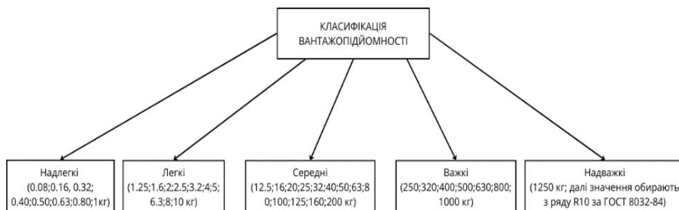
Рисунок 1.9 Блок-схема класифікації вантажопідйомності
