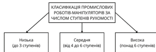
Рисунок 1.10 Блок-схема класифікації промислових роботів-маніпуляторів за числом ступенів рухомості
