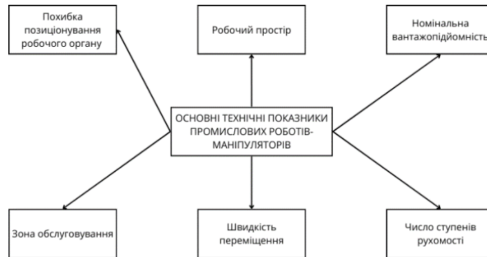
Рисунок 1.8 Блок-схема основних технічних показників промислових роботів
