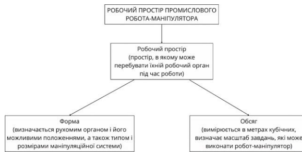
Рисунок 1.11 Опис робочого простору промислового робота-маніпулятора
