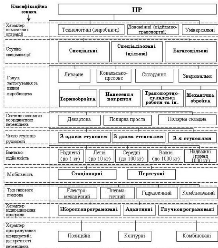
Рисунок 1.6 Класифікація промислових роботів-маніпуляторів
