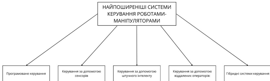
Рисунок 1.19 Схема найпоширеніших систем керування рухами та поведінкою роботів-маніпуляторів
