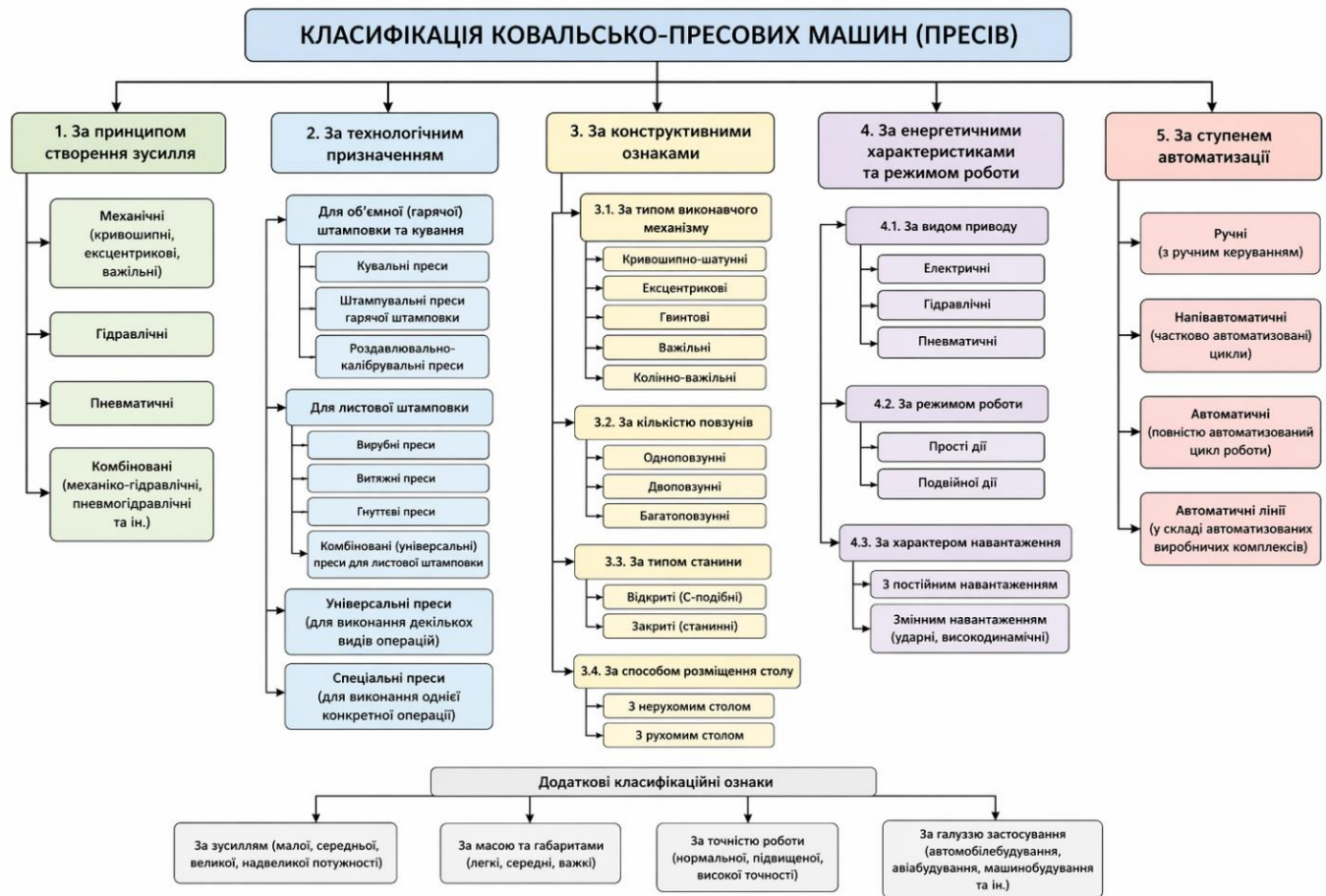
Рисунок 1.1 – Класифікація ковальсько-пресових машин
