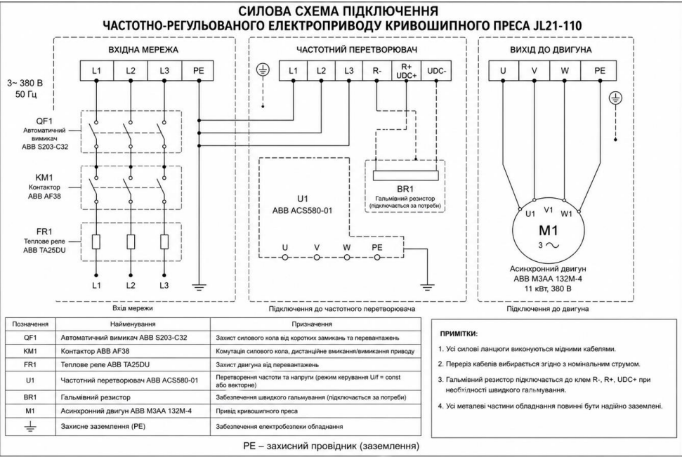
Рисунок 8.1 - Схема підключень електроприводу
